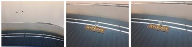
Motorkap, Steenslag, Herstellen en spuiten (compleet)
