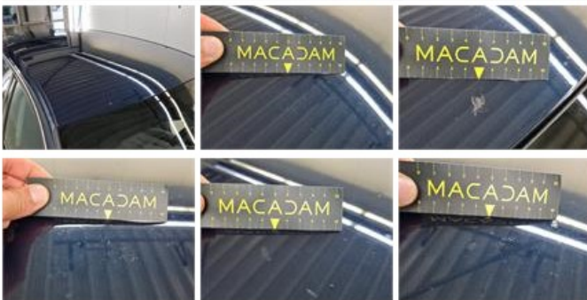
Dak, Chemische schade, Herstellen en spuiten (compleet)
