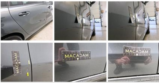
Deur V R, Kras(sen), Herstellen en spuiten (compleet)
