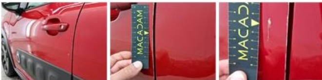
Dakstijl L, Hagelschade, Uitdeuken zonder spuiten (hagelschade)
