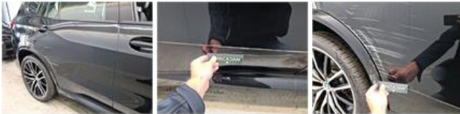
Wielkuip bekleding V R, Kras(sen), Vervangen
