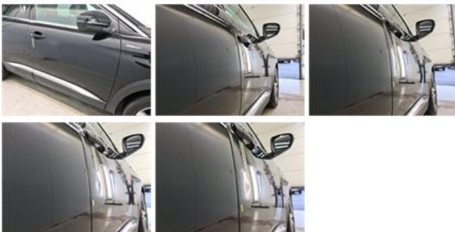
Deur V R, Deuk(en), Herstellen en spuiten (compleet)
