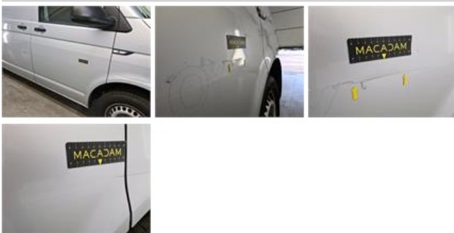
Schuifdeur R, Deuk(en) en kras(sen), Herstellen en spuiten (compleet)
