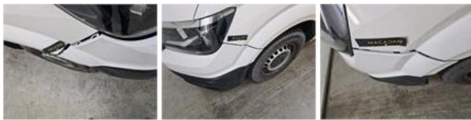
Motorkap, Roest / Corrosie, Herstellen en spuiten (compleet)
