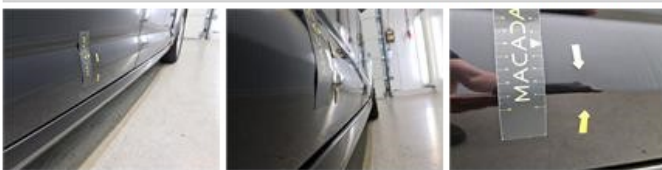
Deur A R, Deuk(en), Herstellen en spuiten (compleet)
