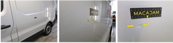
Achterdeur L, Kras(sen), Herstellen en spuiten (compleet)
