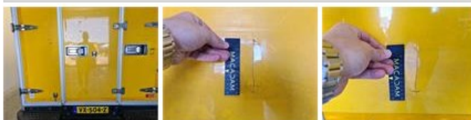
Achterdeur R, Barst, Herstellen en spuiten (compleet)
