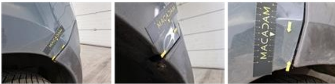
Wielkuip bekleding V R, Gebroken, Vervangen
