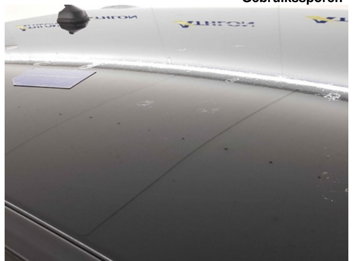
4. Dak ingebrande vogelpoep
