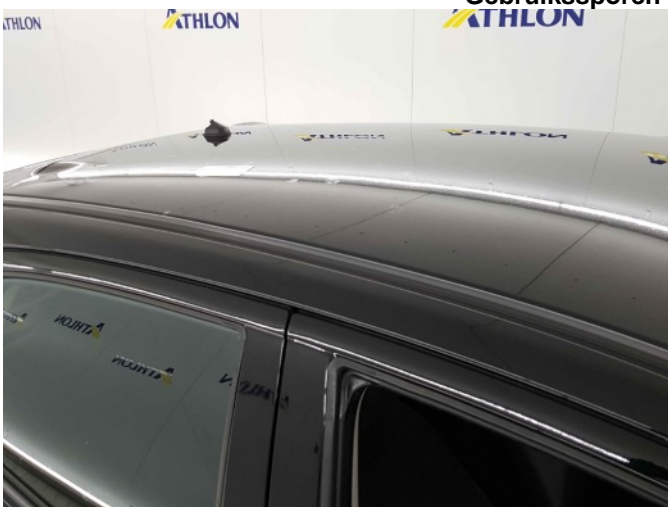
4. Dak ingebrande vogelpoep
