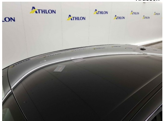
7. Ingebrande vogelpoep dak
