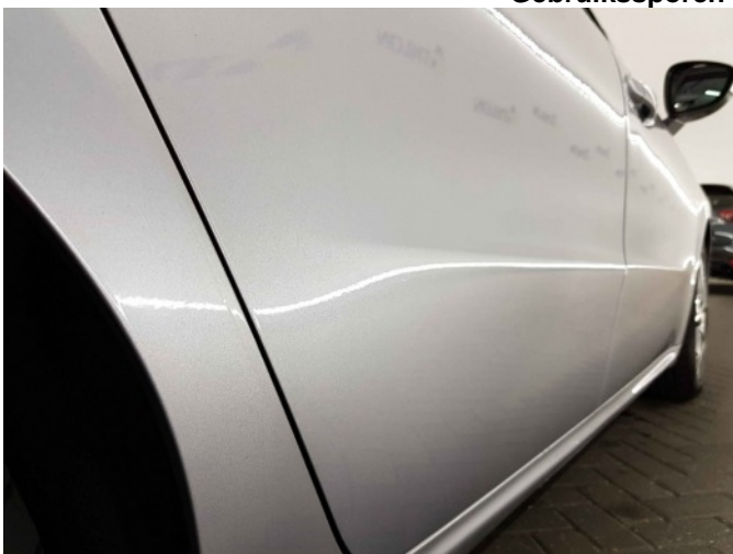
4. Slecht hersteld - rechterzijde
