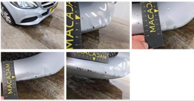
Scherp A R, Kras(sen), Herstellen en spuiten (compleet)
