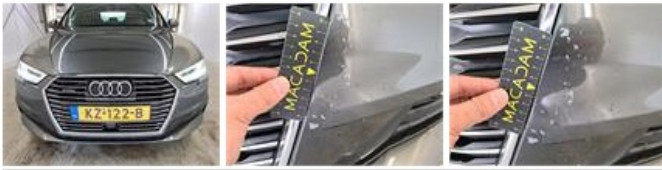
Bumper A, Barst, Herstellen en spuiten (compleet)
