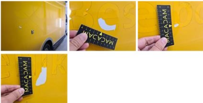
Wielkuip bekleding A L, Kras(sen), Vervangen
