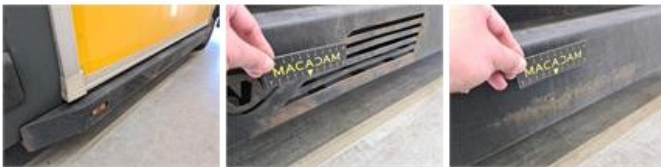
Side bar L, Roest / Corrosie, Vervangen
