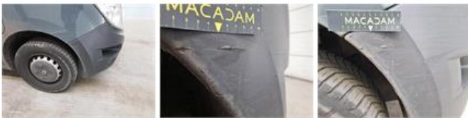
Wielkuip bekleding A L, Kras(sen), Vervangen
