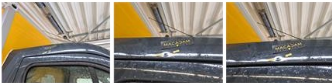
Zijwand A R (Bedr.w), Kras(sen), Herstellen en spuiten (compleet)
