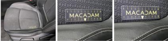
Stoelbekleding zitting VL, Versleten, Vervangen
