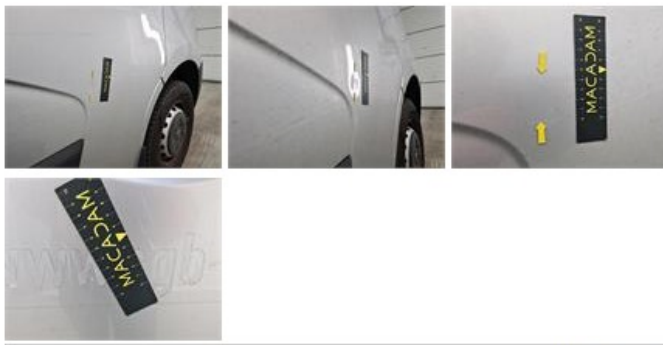
Achterdeur R bekleding, Barst, Vervangen
