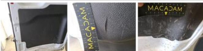
Dak, Roest / Corrosie, Herstellen en spuiten (compleet)
