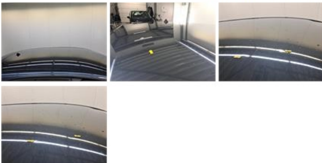
Dak, Hagelschade, Uitdeuken zonder spuiten (hagelschade)
