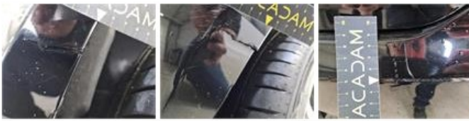
Deur V L, Kras(sen), Herstellen en spuiten (compleet)
