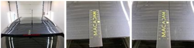
Kofferklep bekleding, Kras(sen), Vervangen
