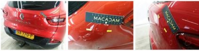
Kofferklep, Deuk(en), Herstellen en spuiten (compleet)
