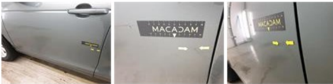
Deur A R, Slecht hersteld, Herstellen en spuiten (compleet)
