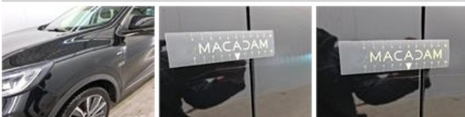
Deur V L, Kras(sen), Herstellen en spuiten (compleet)
