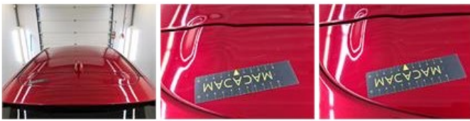
Deur A R, Kras(sen), Herstellen en spuiten (compleet)
