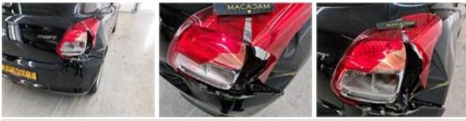
Bumper A, Gebroken, Vervangen en spuiten
