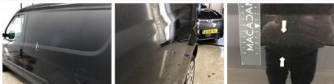
Deur V R, Deuk(en), Herstellen en spuiten (compleet)
